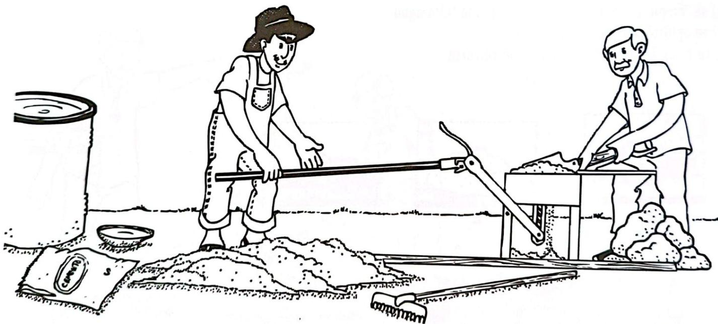
Se prensa la mezcla bajando la palanca hasta que llegue al final de su recorrido.
